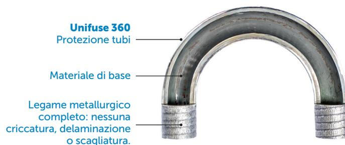
Sezione trasversale di un tubo piegato curvato
