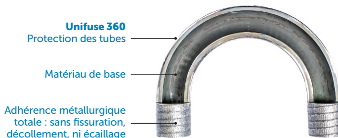
Vue en coupe d'un tube cintré
