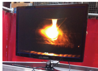
Nozzlefuse 624: La cámara integrada proporciona un control visual del recargue en tiempo real
