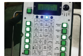
Nozzlefuse 624: Steuerschalter: Robuste Parametersteuerung für einfache Bedienung
