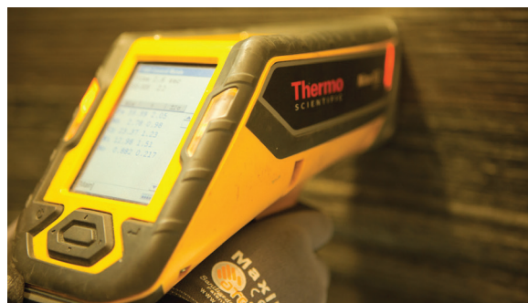
Ispezione PMI/FN mediante XRF
