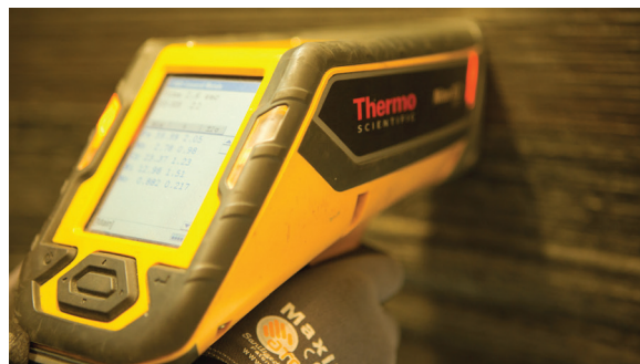
Mesure PMI/Indice de ferrite (FN) en utilisant la technologie de spectrométrie de fluorescence X (XRF)
