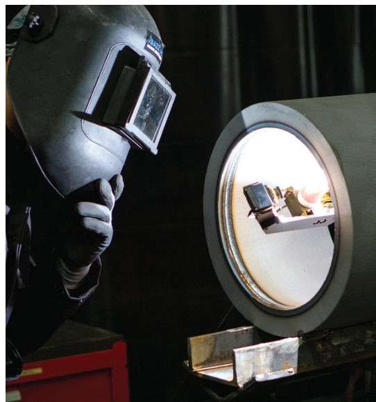
WSI ofrece una solución de reparación totalmente automatizada para un diámetro de inyector desde 2" hasta tubuladuras y bocas de hombre de 24"
