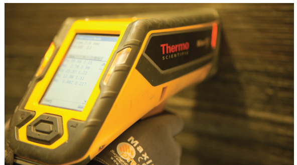
Inspección PMI/FN mediante XRF
