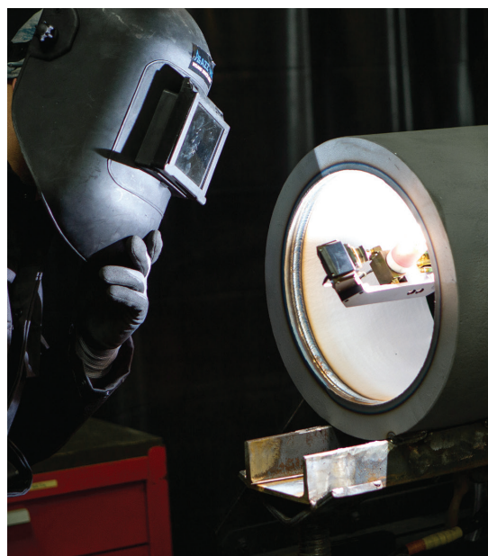
WSI bietet eine einzigartige, voll automatisierte Reparaturlösung für Stützendurchmesser zwischen 5 cm (2") und 60 cm (24").
