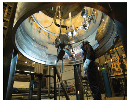
Modellerstellung für automatisches Auftragschweißen
