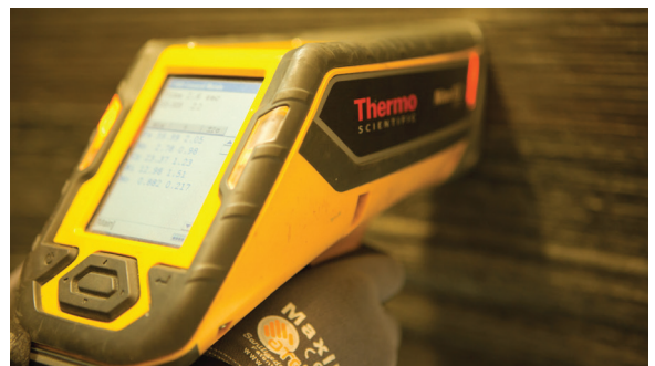
PMI/FN-Inspektion unter Einsatz des XRF-Verfahrens
