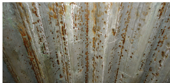
Parete membranata dopo il test del solfato di rame
