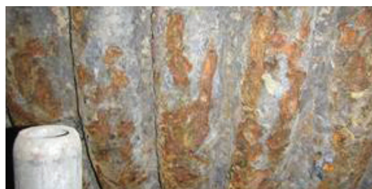
Corrosione lato fiamma in una caldaia a carbone
