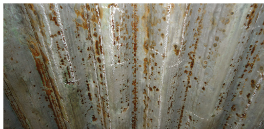
Pared de agua tras la prueba del sulfato de cobre
