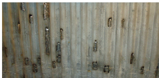
Reparaciones puntuales en un viejo recargue con soldadura 625
