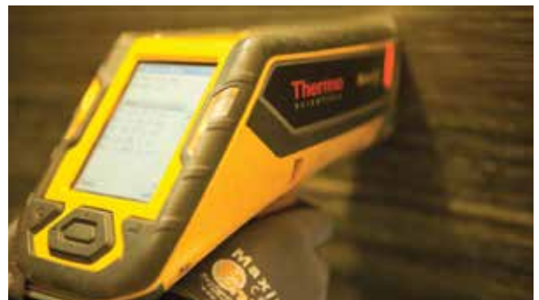
Inspección PMI/FN mediante XRF
