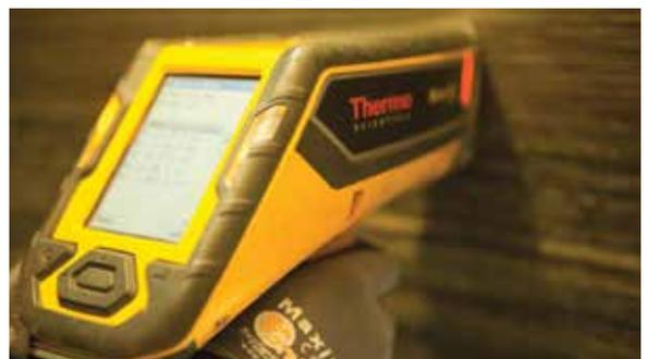
Ispezione PMI/FN mediante XRF
