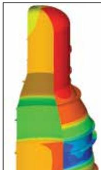
Simulazione a colori delle deformazioni in una Vacuum Tower
