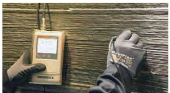
Letture UT dello spessore del rivestimento
