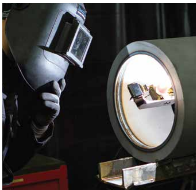
WSI offre une solution unique de réparation sur site entièrement automatisée pour le diamètre intérieur de piquage allant de 50 à 610mm
