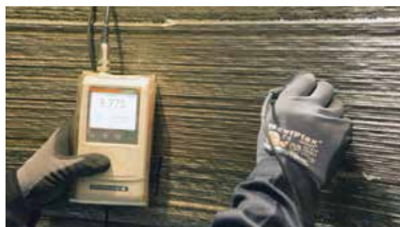
Mesure de l'épaisseur
