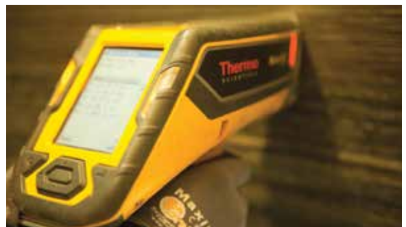
PMI/FN-Inspektion unter Einsatz des XRF-Verfahrens
