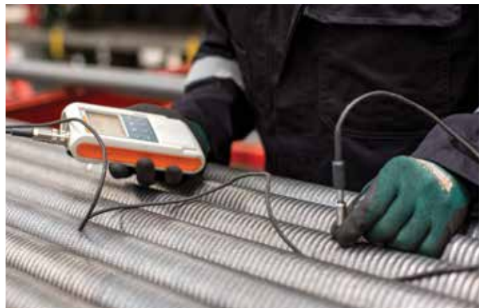
Inspección de los tubos 360
