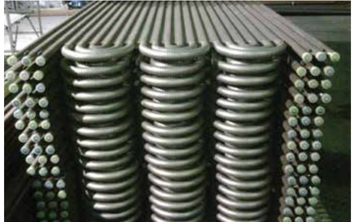
Serpentín de sobrecalentador
