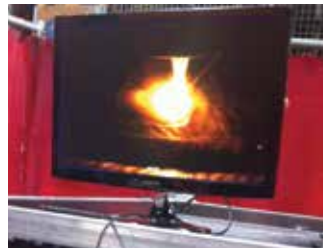
Nozzlefuse 624: La cámara integrada proporciona un control visual del recubrimiento en tiempo real
