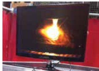
Nozzlefuse 624: videocamera incorporata per un controllo visivo in tempo reale del riporto
