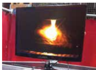
Nozzlefuse 624 : La caméra intégrée permet un contrôle visuel en temps réel du recouvrement
