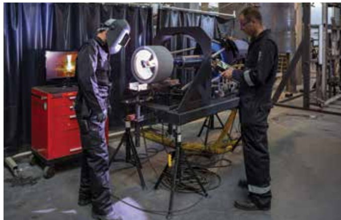
Rechargement d'un piquage avec Nozzlefuse 624
