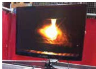
Nozzlefuse 624: A câmera integrada fornece um controle visual em tempo real do revestimento
