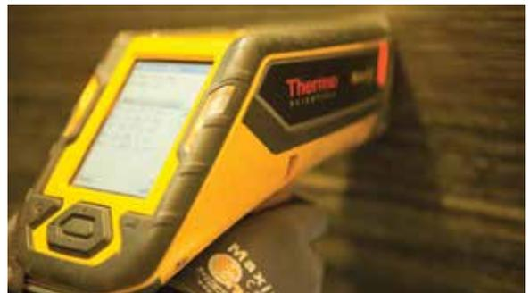
Inspección PMI/FN mediante XRF
