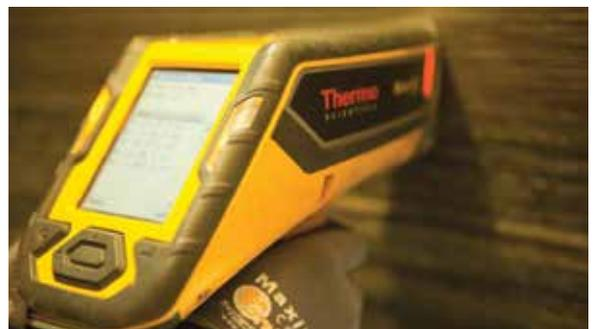
Inspeção PMI/Ferrite Number com o uso de fluorescência RX (XRF)
