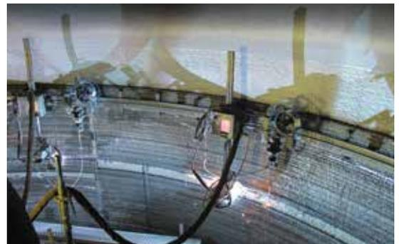
Soldagem de revestimento automatizada utilizando o processo Unifuse
