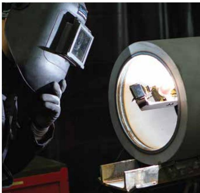
A WSI oferece uma solução de reparo exclusiva e totalmente automatizada para diâmetros internos de bocais de 2 polegadas a 24 polegadas
