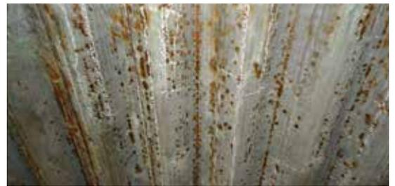
*Pared de agua tras la prueba del sulfato de cobre*
