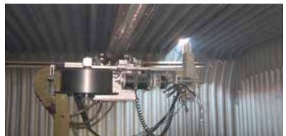
Wenn der Schaden großflächig ist, sollte die Unifuse Auftragsschweißung automatisch durchgeführt werden, um die erforderliche Dicke der Auftragsschweißschicht wieder herzustellen.
