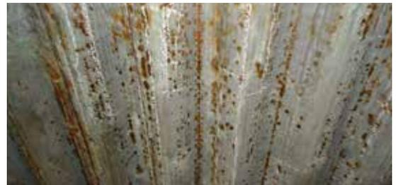
*Parede tubo-tubo após o ensaio por sulfato de cobre*
