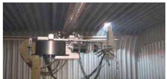
*Se o dano é extenso, uma solda de revestimento automática deve ser realizada para reestabelecer a espessura de revestimento requerida*
