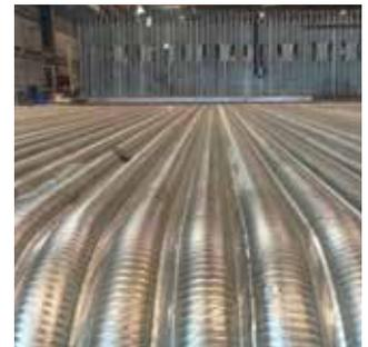
Painel fabricado com tubos em espiral
